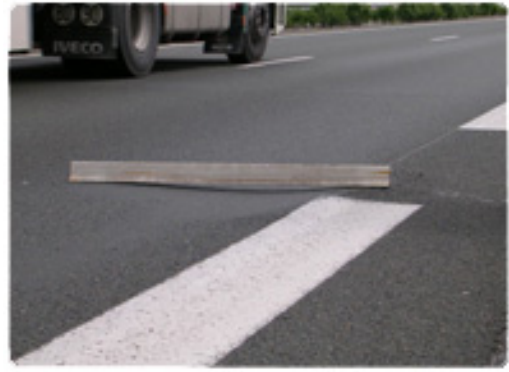
Orniérage moyen 7 à 8 mm, très exceptionnellement 12 à 18 mm
